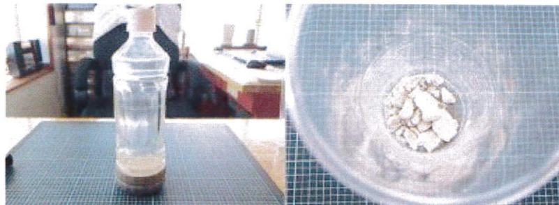
水と固形物を分離（左）脱水後の固形物
